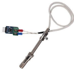
Gambar 2.8 Termokopel Tipe K dan Max6675
